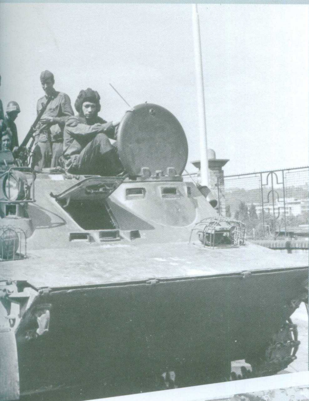
★ БТР-50ПК возвращается с парада на Красной площади. Прямоугольный люк в крыше десантного отделения закрывался двухстворчатой крышкой.
