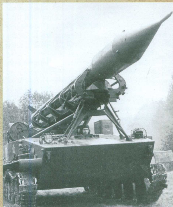
★ Пусковая установка 2П16 комплекса 2К6 «Луна» с ракетой ЗР10, оснащенной надкалиберной головной частью ЗН14 для ядерного заряда.
